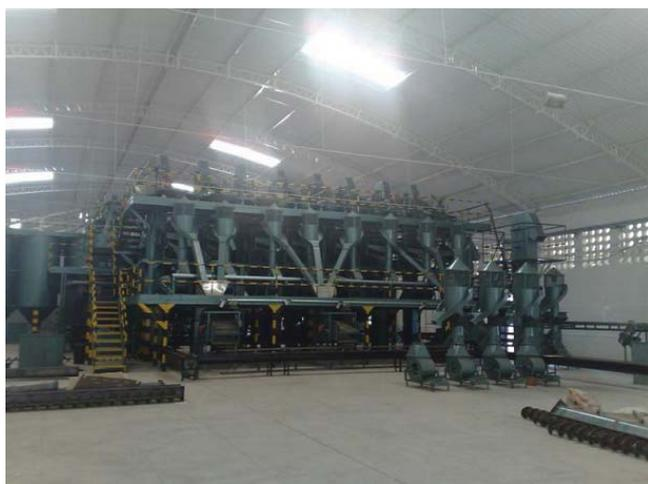
Nova máquina de descascamento (capacidade de 30.000 TM)
