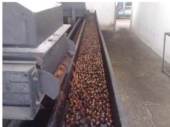
Esteira transportadora depois dos fornos e das máquinas centrifugadoras
